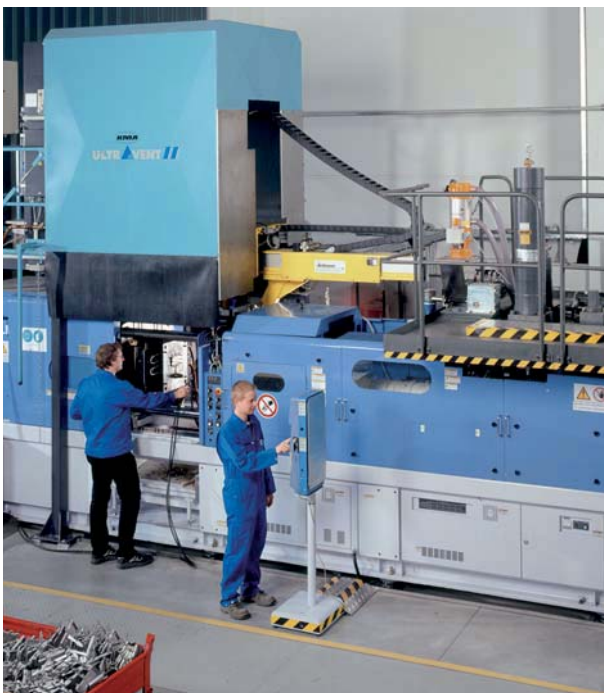
Thixospritzgießmaschine mit 220 t Schließkraft bei Neue Materialien Fürth GmbH
