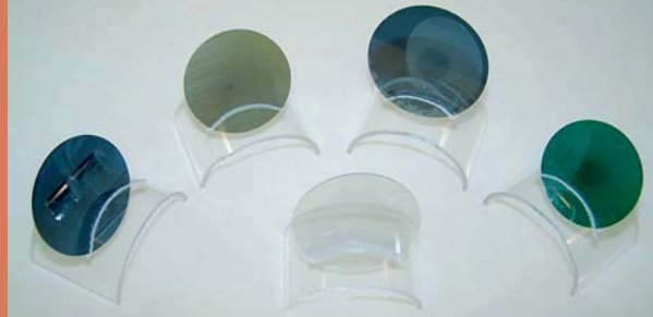
Kristallscheiben aus Siliziumkarbid (SiC) sind transparent, erhalten aber bereits durch geringe Konzentrationen an Dotierstoffen eine charakteristische Färbung.
