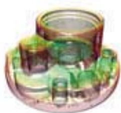
Computertomographie eines Werkstücks zur Materialprüfung
